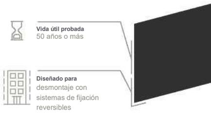
Con una vida útil prevista de 50 años o más, los paneles EQUITONE suelen durar más que la vida útil de la construcción. Están diseñados para ser desmontados con sistemas de fijación reversibles, lo que permite su reutilización en revestimientos de fachadas u otras aplicaciones.
