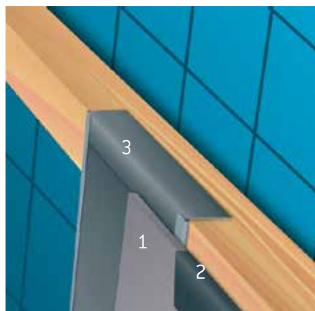
Fugenausbildung mit Fugenblech vom First aus betrachtet
