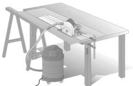
En cas de travail sur le panneau, celui-ci doit être suffisamment soutenu de manière à ce qu'il ne puisse pas plier. La table de sciage doit être très stable et ne peut pas vibrer. Le panneau ne peut pas être mis sous tension pendant le sciage. Un panneau exempt de toute vibration et tension est indispensable pour une bonne coupe.
