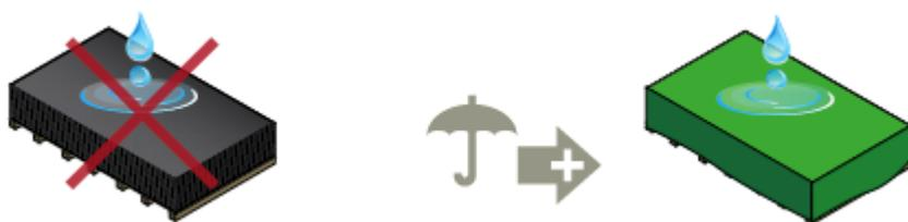
Les panneaux doivent être empilés à l'horizontale sur une surface plane. Les panneaux doivent toujours être suffisamment soutenus pour ne pas se déformer.
