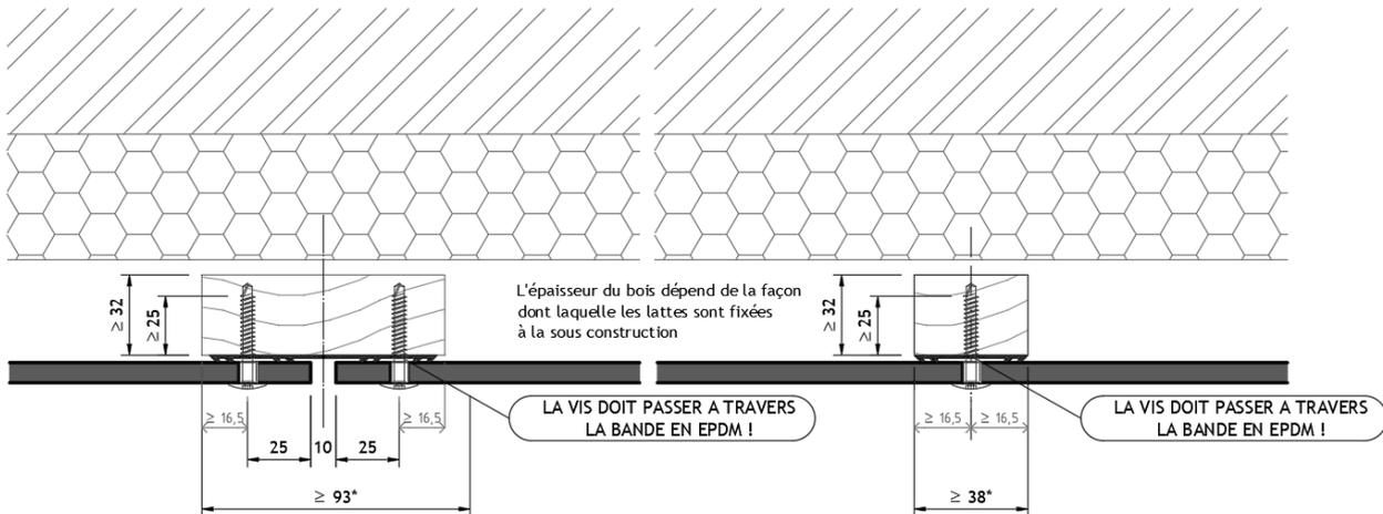
La profondeur minimale de la section filetée des vis dans les lattes de support en bois est de 25 mm.
