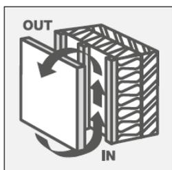
Prévoyez au moins **100 cm<sup>2</sup>/m<sup>2</sup>** d'entrée et de sortie d'air en association avec un **vide d'air ininterrompu** directement derrière les panneaux de façade EQUITONE.
