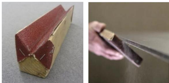
Lors de cette opération, le bloc de ponçage en forme de V est déplacé sur le bord scié environ trois fois avec une pression légère mais régulière afin que l'angle aigu entre les surfaces soit subtilement chanfreiné.
