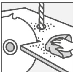
Retirez immédiatement la poussière de découpe et de forage au moyen d'un chiffon en microfibres propre ou d'une brosse.
