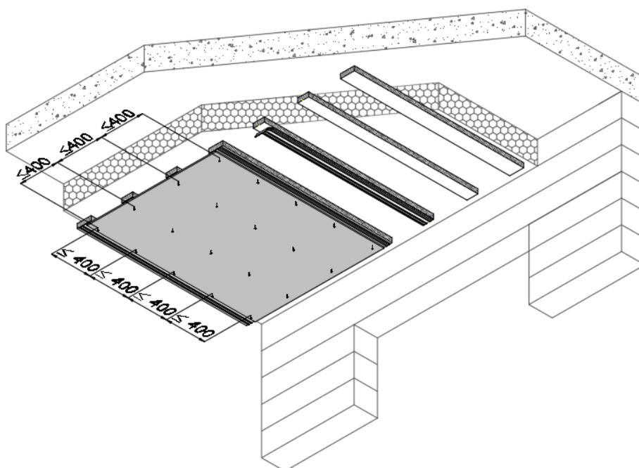
**Configuration des trous de vis pour des linteaux horizontaux au-dessus des ouvertures de fenêtres et de portes**
