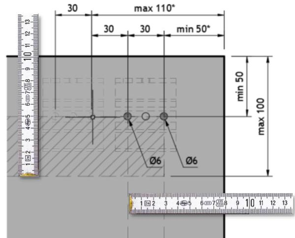
\* Distance horizontale entre le bord vertical du panneau et le centre du trou le plus proche de ce bord
