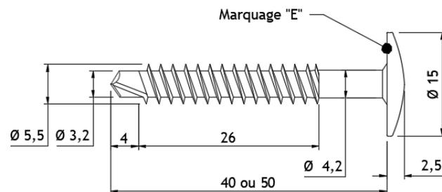
Les têtes des UNI-Vis EQUITONE AF sont peintes dans la couleur du panneau de façade EQUITONE. Le système de coating est un processus en deux couches avec utilisation d'un primer epoxy et application d'une couche de finition en polyuréthane 2K (PUR).
