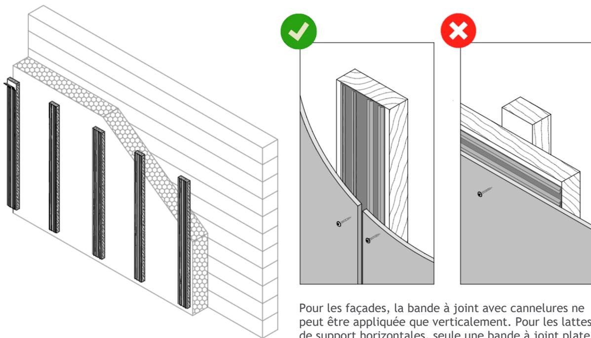
Pour les façades, la bande à joint avec cannelures ne peut être appliquée que verticalement. Pour les lattes de support horizontales, seule une bande à joint plate en EPDM est autorisée.
