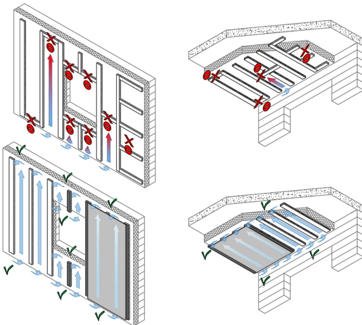
La largeur du vide, soit l'espace libre entre le dos du panneau de façade et l'isolation ou la construction dépendra de la hauteur du bâtiment. Plus la façade sera haute ou le plafond sera long, plus le vide d'air devra être large. Les valeurs minimales en vigueur en Belgique et au Grand-Duché de Luxembourg sont les suivantes :
