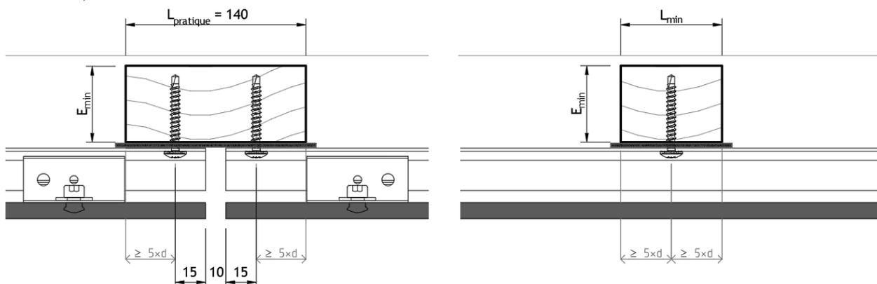
Il convient de tenir compte de la dilatation des rails de support horizontaux. L'étude de la façade (à effectuer par des tiers) choisira et déterminera la méthode de fixation en fonction de la longueur de ces rails.
