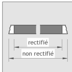
Seuls les panneaux rectifiés peuvent être utilisés. Les panneaux non rectifiés doivent toujours être découpés sur les 4 côtés.
