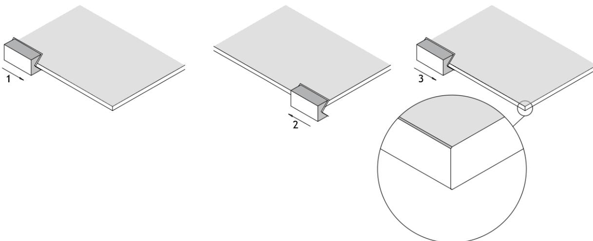
Si l'on utilise un bloc de ponçage plat, il est préférable d'effectuer cette opération en trois étapes ; La première consistera à poncer le bord du côté scié à plat (1 et 2), alors que les phases deux et trois consisteront à poncer légèrement l'arête entre le côté apparent et le chant (3) ainsi que l'arrête entre le dos du panneau et le chant (4).
