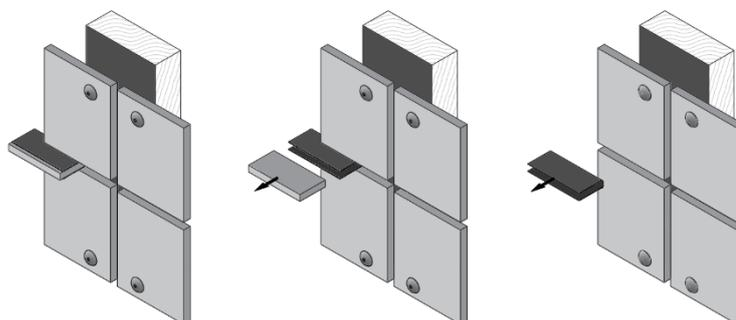
Les panneaux sont vissés à la structure portante verticale en bois avec les UNI-Vis EQUITONE décrites ci-dessus. Il est important dans ce cas que les vis soit précisément à la perpendiculaire dans le bois et de manière centrale par rapport au trou de forage. Si la vis est placée correctement, le trou de forage sera joliment recouvert par la tête et aucune infiltration d'eau ne sera possible.
