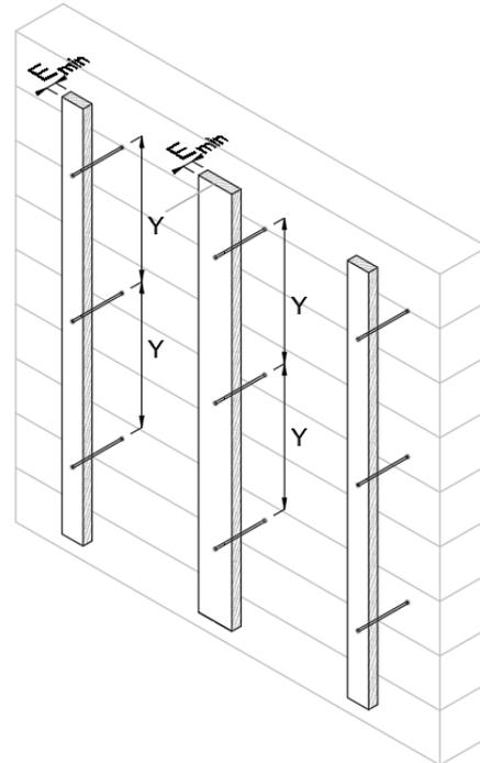
**Pour la fixation mécanique visible avec des UNI-Vis EQUITONE AF**
