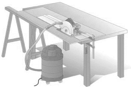
En cas de travail sur le panneau, celui-ci doit être suffisamment soutenu de manière à ce qu'il ne puisse pas plier. La table de sciage doit être très stable et ne peut pas vibrer. Le panneau ne peut pas être mis sous tension pendant le sciage. Un panneau exempt de toute vibration et tension est indispensable pour une bonne coupe.
